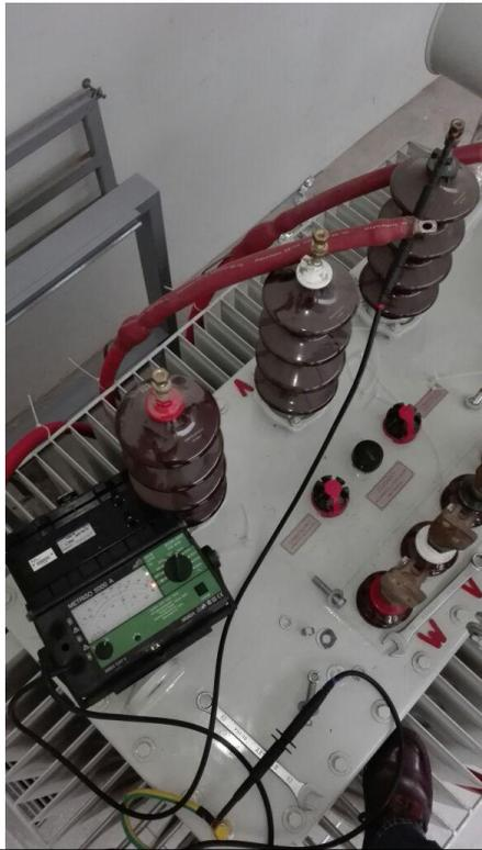
Mantenimiento y megado de bobinados internos en transformadores de potencia con equipo Megometro certificado y calibrado
